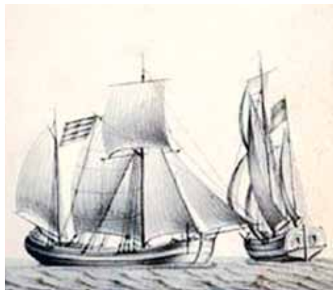
Til venstre på billedet en galeot/galliot, der er rundgattet (runt agterparti). Til højre på billedet en galease, der er spejlgattet (fladt agterparti). Efter billede i Handels- og Søfartsmuseet i Helsingør.
